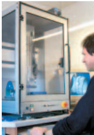
Moderne Techniken und Handarbeit: IN der CNC-Fräse entstehen Rohlinge für Schmuck
