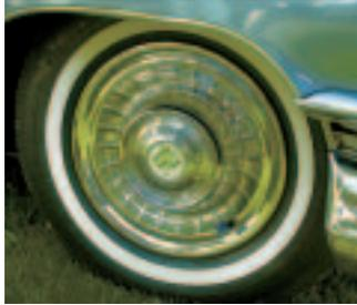
Ein Hersteller solcher Ringe ist die Gronauer Firma Ravus, die dafür das thermoplastische Polyurethan (TPU) Desmopan® der Bayer Material-Science AG einsetzt. Dieser Werkstoff ist besonders abriebfest. Deshalb sollen die Ringe im Gegensatz zu entsprechenden Pendanten aus Kautschuk wesentlich verschleißfester sein. Für die lange Lebensdauer der Ringe sorgt neben der großen chemischen Beständigkeit und UV-Stabilität auch die hohe Schlagzähigkeit, Reiß- und
