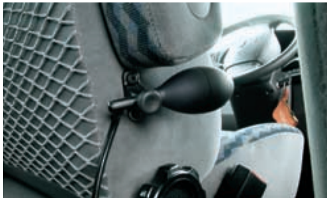
Keine Angst, diese Pumpe misst nicht den Blutdruck. Ein aufblasbares Kissen in der Sitzlehne soll für gesundes Sitzen sorgen
