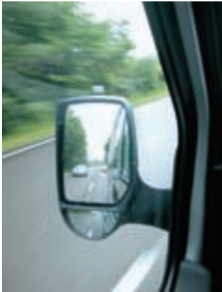
Die Trennung im unteren Drittel des Rückspiegels schafft ein geordnetes Blickfeld
