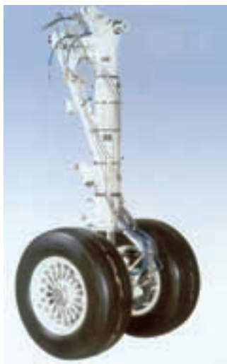
„Embraer 190 Main Landing Gear“ – eines der Fahrwerke, die bei Liebherr-Aerospace hergestellt werden Foto: Liebherr
