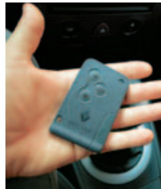
Hands Free Entry Drive Card- der Name ist das einzig verwirrende an diesem genialen System. Einen Schlüssel im eigentlichen Sinn gibt es nicht, außer einen Notschlüssel in der Karte. Die Karte in der Tasche genügt – ein Einschub ist nicht erforderlich.
