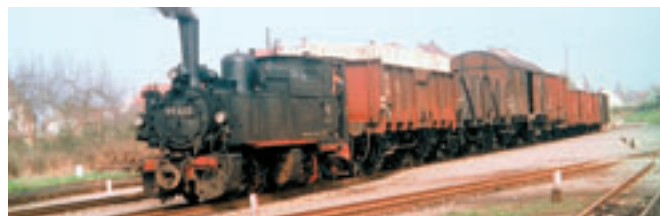
Ein Bild aus den 60er-Jahren: Die Normalspur-Waggons wurden auf Schmalspur-Fahrgestelle gesetzt um weiterfahren zu können
