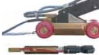
Bild 1: Verschieden große Kameras für verschieden große Rohrdurchmesser
