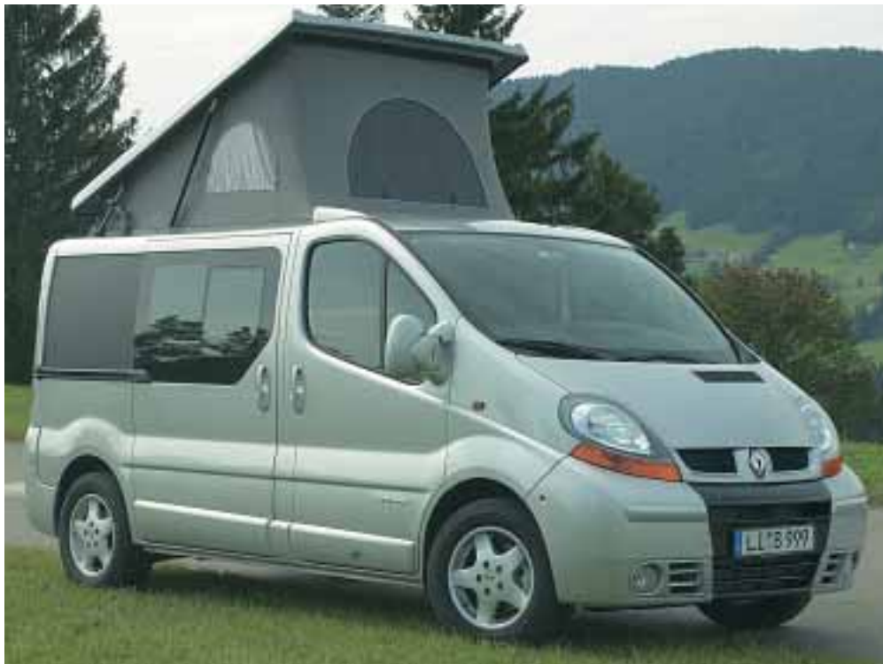
Der Renault von BavariaCamp ist mit oder ohne „Mütze“ zu haben. Mit Aufstelldach heißt er Scout, ohne heißt er Qbus. Im Inneren ist Platz für 5 Fahrgäste. 4 Schlafplätze bieten bei Bedarf komfortables Camping. Dank Zusatzheizung ist der Renault auch in der kalten Jahreszeit gut als Reisefahrzeug nutzbar. Foto: AL
